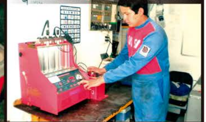
Probando la presión de la bomba con el ECO-126
